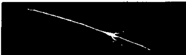
图 329 喇叭形爆花E 合金结构钢内含硅2.50~3.00%、碳0.15~0.25%
