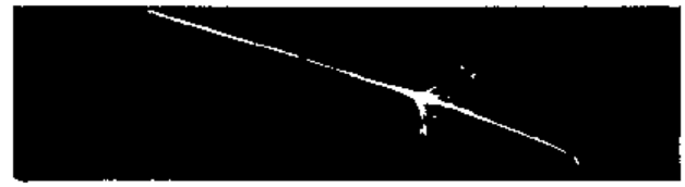
图 328 喇叭形爆花D 合金结构钢内含硅2.00~2.50%、碳0.40~0.50%
