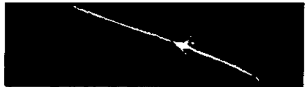
图 330 喇叭形爆花F 合金结构钢内含硅3.00~3.50%、碳0.20~0.30%
